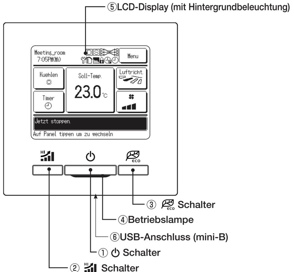
Ein Touchscreen-System, das durch Berühren der LCD-Anzeige mit dem Finger bedient wird, kommt für alle Bedienungsschritte zum Einsatz, abgesehen von den Optionen ① Lauf/Stop, ② High-Power und ③ Energiesparbetrieb, die über die entsprechenden Schalter aktiviert werden.
